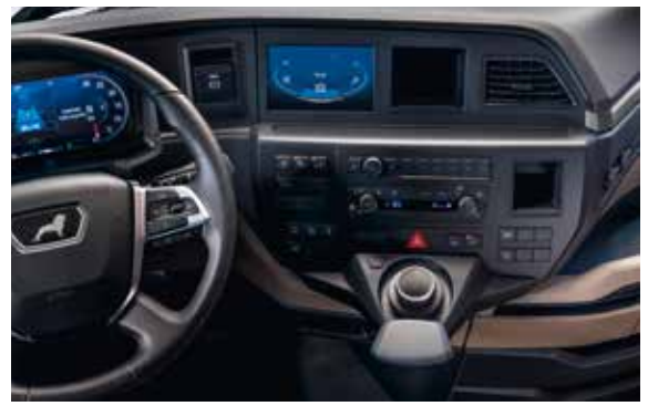
Système d'infodivertissement avec écran 7" et MAN SmartSelect
